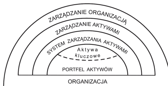
Rys. 3. Zależności pomiędzy kluczowymi terminami w ISO 55 000
