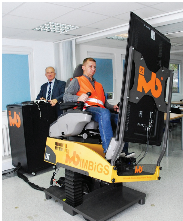
Rys. 1. Symulator koparki jednonaczyniowej EC210C Fig. 1. Single-van excavator simulator EC210C
