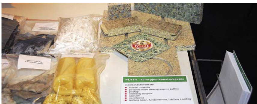
Próbki płyt izolacyjno-konstrukcyjnych oraz odpadów wielomateriałowych
