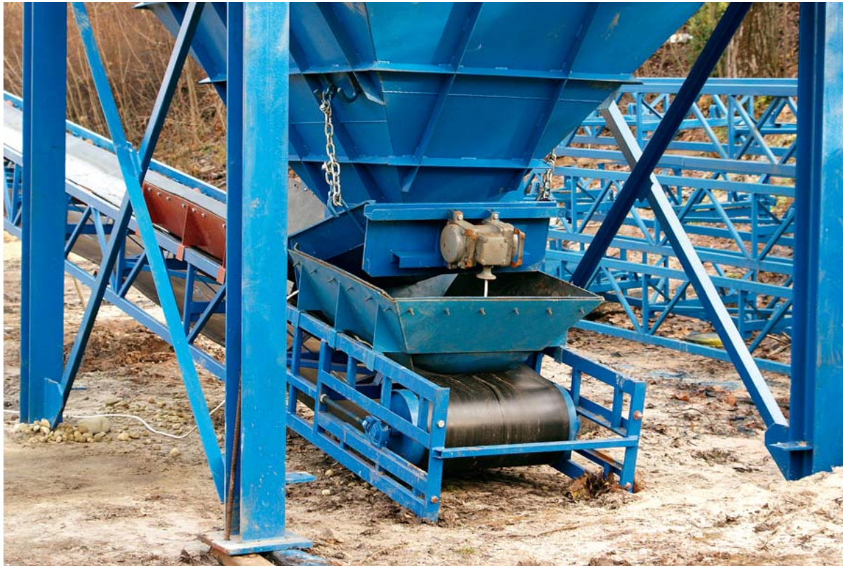
Fot. 1. Widok podajnika wibracyjnego o kołowym wymuszeniu drgań (stąd pochyla rynna podająca)
