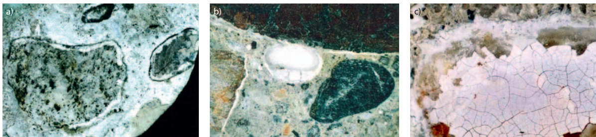
Rys. 1. Obraz ziarn z objawami reaktywności alkalicznej [1]: a) obrzeże reakcji w gnejsie, b) kieszeń żelowa w pustych przestrzeniach w mułowcu reaktywnym, c) żel ASR na powierzchni pęknięć reaktywnego rogowca
