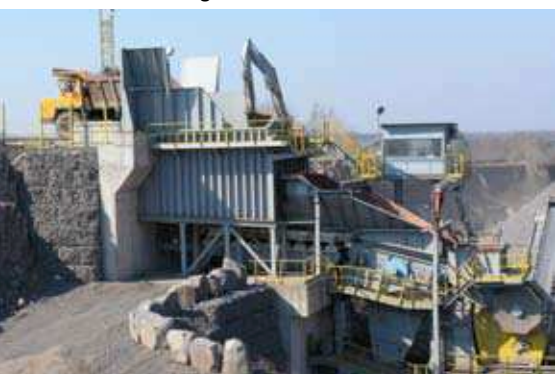
Kopalnia Księginki II, załadunek surowca skalnego do kruszarki
