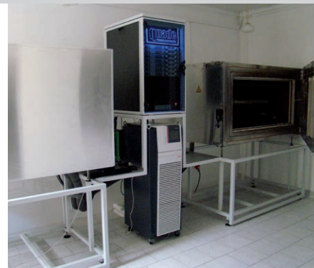
FOT. Aparat rurowy Quade do pomiarów współczynnika przewodzenia ciepła otulin w zakresie od -40°C do 600°C
