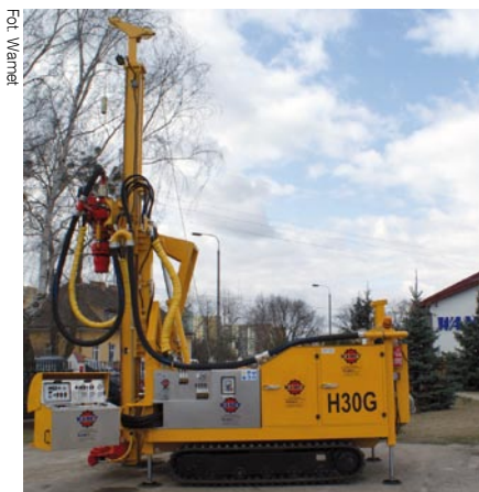
Fot. 1. Wiertnica H30G na podwoziu gąsienicowym
