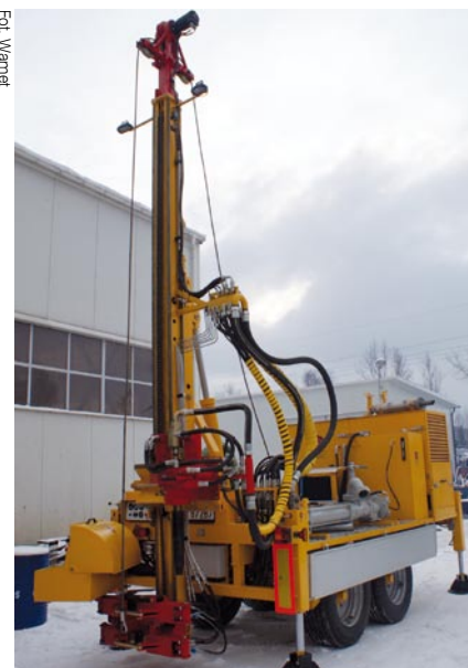
Fot. 3. Wiertnica H30P zabudowana na przyczepie
