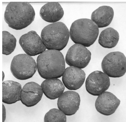
Rys. 2. Kruszywa sztuczne lekkie otrzymane z zastosowaniem odpadów po wzbogacaniu mułów węglowych, spiekane w temperaturze 1100°C
