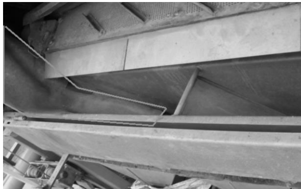
Zdj. 2b. Zabudowa fartucha umożliwiająca odbiór z końcowej części płyty roboczej rozdzielonego materiału do produktu pośredniego
