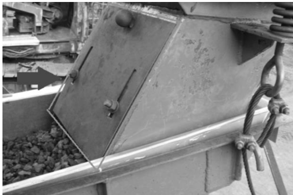
Zdj. 4. Zabudowa kłapy regulacyjnej na rynnie podawczej do podajnika
