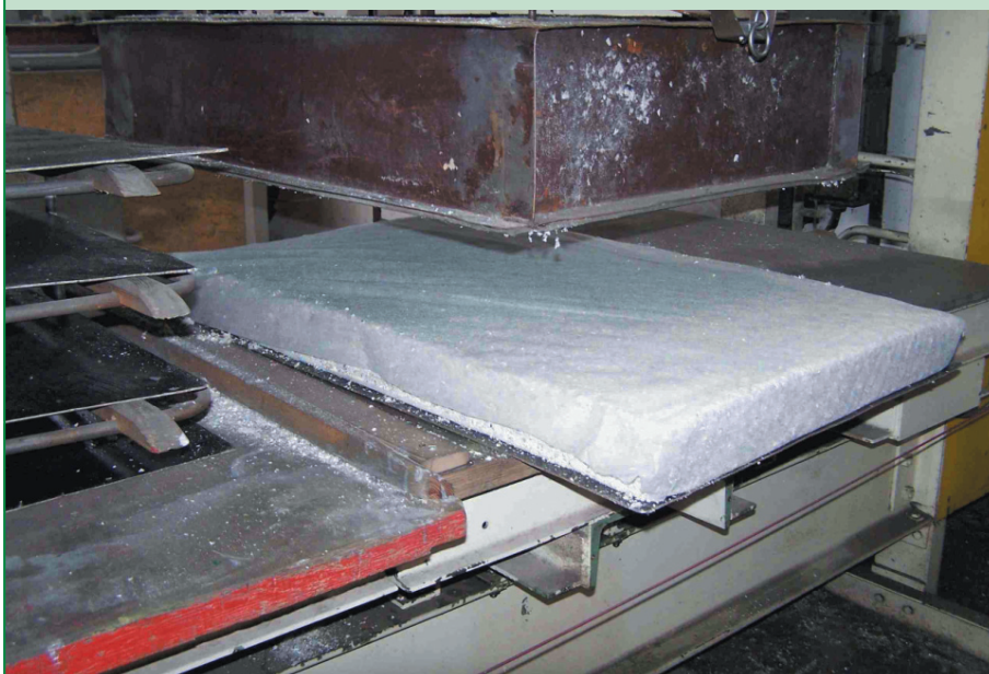
Fot. 1. Wstępnie zaformowana płyta – „arkusz płytowy”
