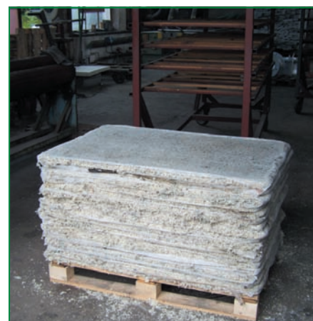
Fot. 2. Płyta po prasowaniu na gorąco – „płyta surowa”
