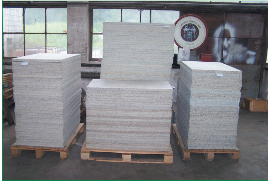
Fot. 3. Seria prototypowych płyt po obcięciu – „płyty gotowe”
