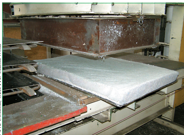
Fot. 1. Wstępnie sformowana płyta — „arkusz płytowy”
