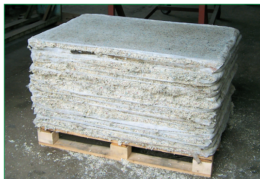
Fot. 2. Płyta po prasowaniu na gorąco — „płyta surowa”
