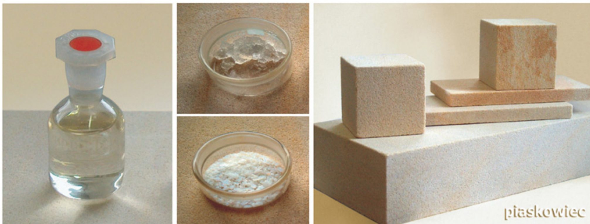
Impregnat: A – w płynie, B – żel (wysychanie), C – skryształizowany, D - zaimpregnowany kamień
