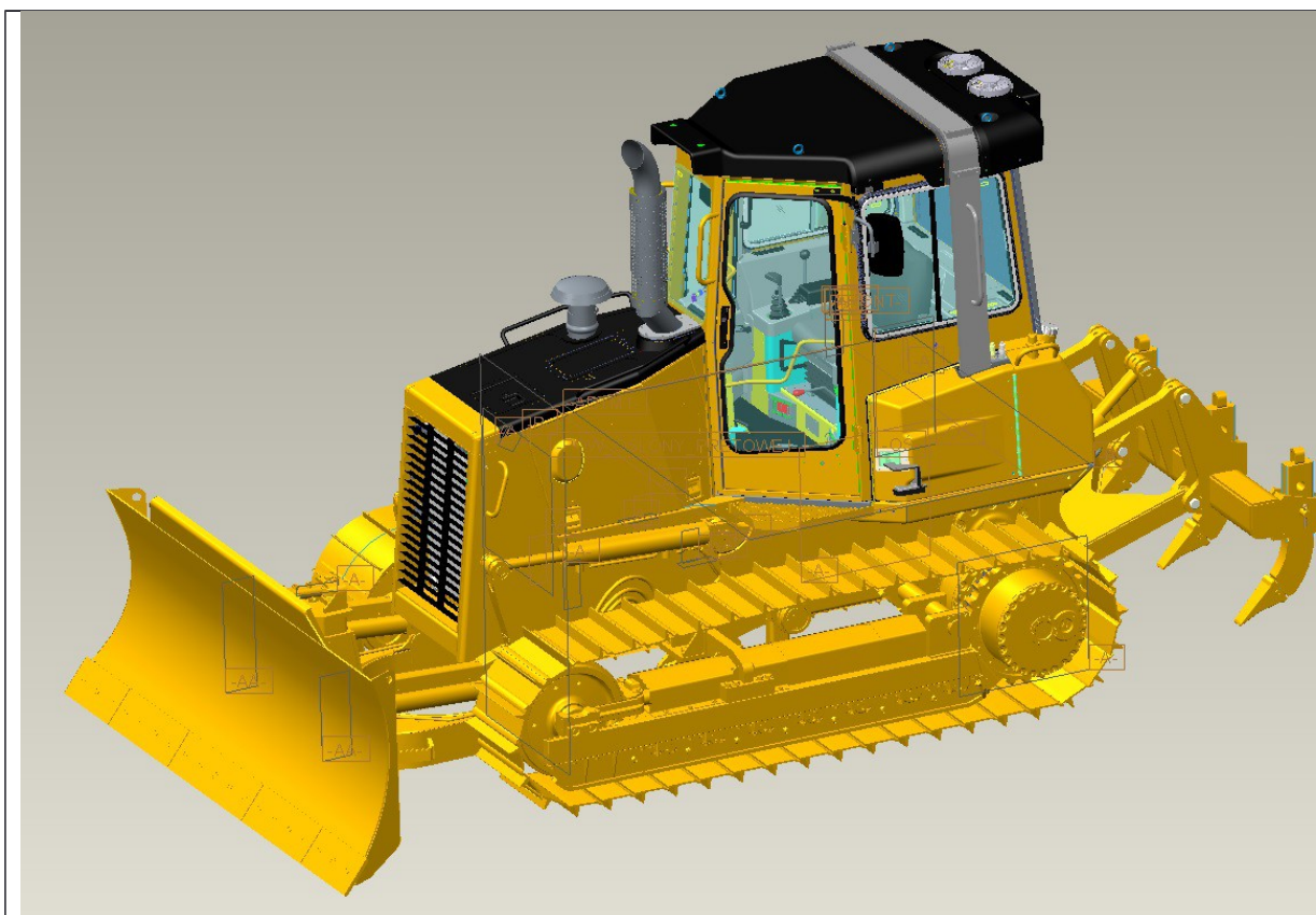
Rys. 1. Model maszyny wygenerowany z modeli poszczególnych podzespołów
